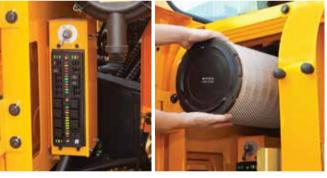
El acceso a nivel del suelo a filtros, empalmes para lubricación, fusibles, componentes de la computadora de la máquina y compartimientos abiertos hacen que el servicio sea más conveniente en las excavadoras Serie 9SB.
