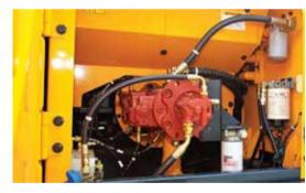
Para lograr una precisión óptima, Hyundai rediseñó el sistema hidráulico para brindar al operador un toque de primera calidad y control mejorado. El control mejorado del flujo de la bomba reduce el flujo cuando los controles no se usan para minimizar el consumo de combustible.
